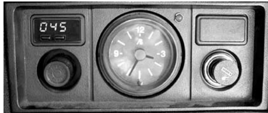
Рис.1 Вид установленного БК в консоли а/м ВАЗ 2107
