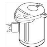
**Розлив с помощью чашки** возможен при надавливании чашкой на специальный рычажок, расположенный у носика термопота. Ни в коем случае не нажимайте на рычажок рукой.
