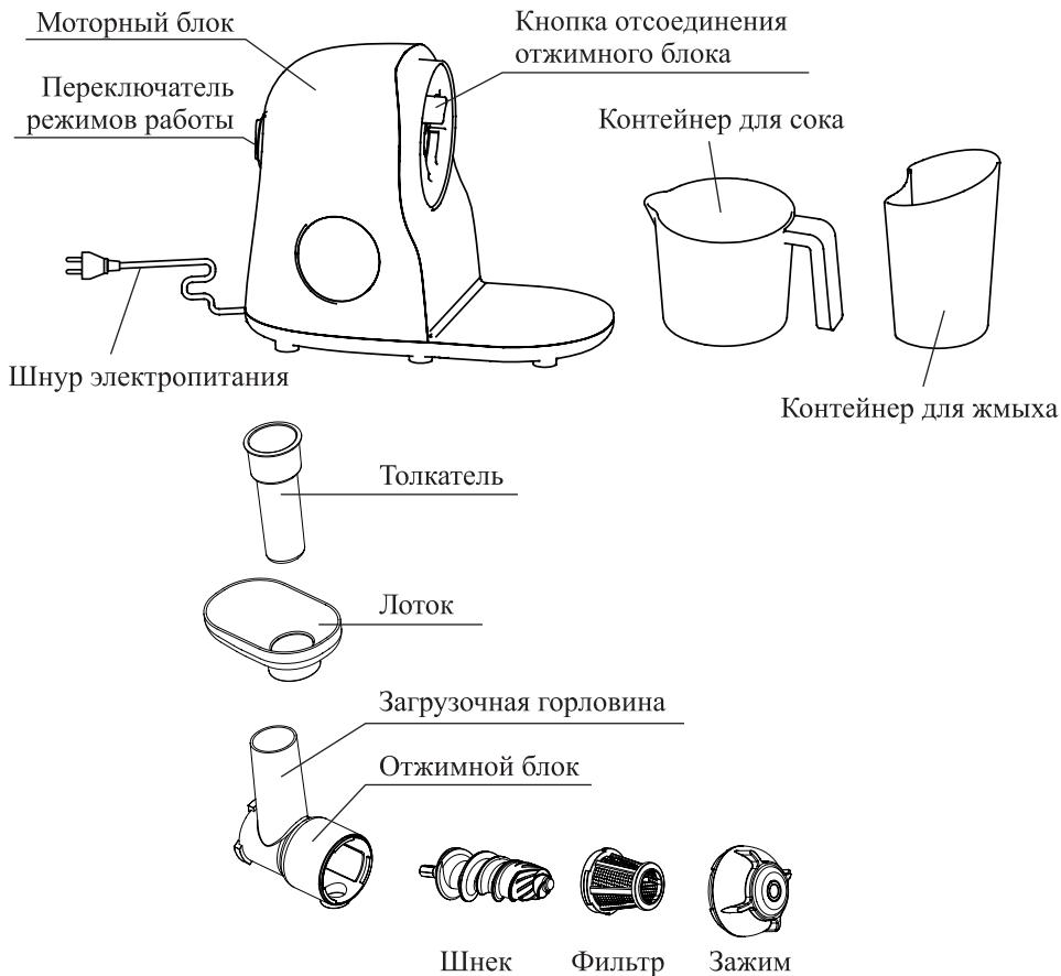
В соковыжималке установлен двигатель постоянного тока. Совместно с двигателем применен понижающий редуктор, благодаря чему крутящий момент на оси шнека увеличивается, и поэтому соковыжималка отжимает сок даже из твердых продуктов, таких как свекла, морковь и пр., включая зелень и листовые овощи. Шестерни и подшипники в редукторе хорошо смазаны, так что пользователю нет никакой необходимости когда-либо производить их смазку.
