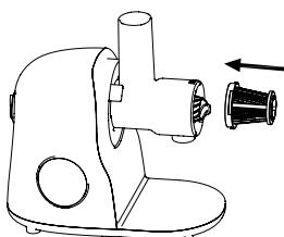
Фильтр устанавливается широкой стороной внутрь отжимного блока. При установке фильтра выступы на его краю должны попасть в соответствующие прорези на отжимном блоке. Фильтр устанавливается до упора, поворачивать его для фиксации не требуется.
