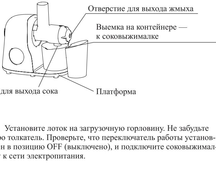
Установите лоток на загрузочную горловину. Не забудьте про толкатель. Проверьте, что переключатель работы установлен в позицию OFF (выключено), и подключите соковыжималку к сети электропитания.
