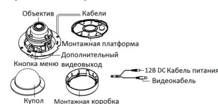
Рисунок 1-14 Купольная камера III типа
