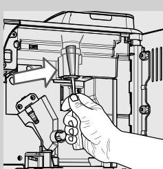
**5** До конца очистить канал выхода кофе рукояткой чайной ложки или любым другим закругленным кухонным инструментом.
