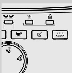
**14** По окончании ополаскивания, светодиод **CALC CLEAN** гаснет; удаление накипи завершено.
