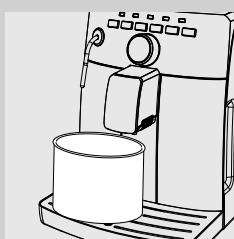
**13** После этого начнется подача раствора для удаления накипи из трубки пара/горячей воды (кнопка будет ровно гореть) и устройства подачи (кнопка будет ровно гореть).
