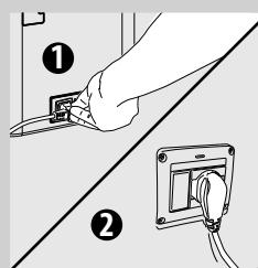
**10** Вставьте штепсельную вилку в розетку, расположенную в задней части машины.
