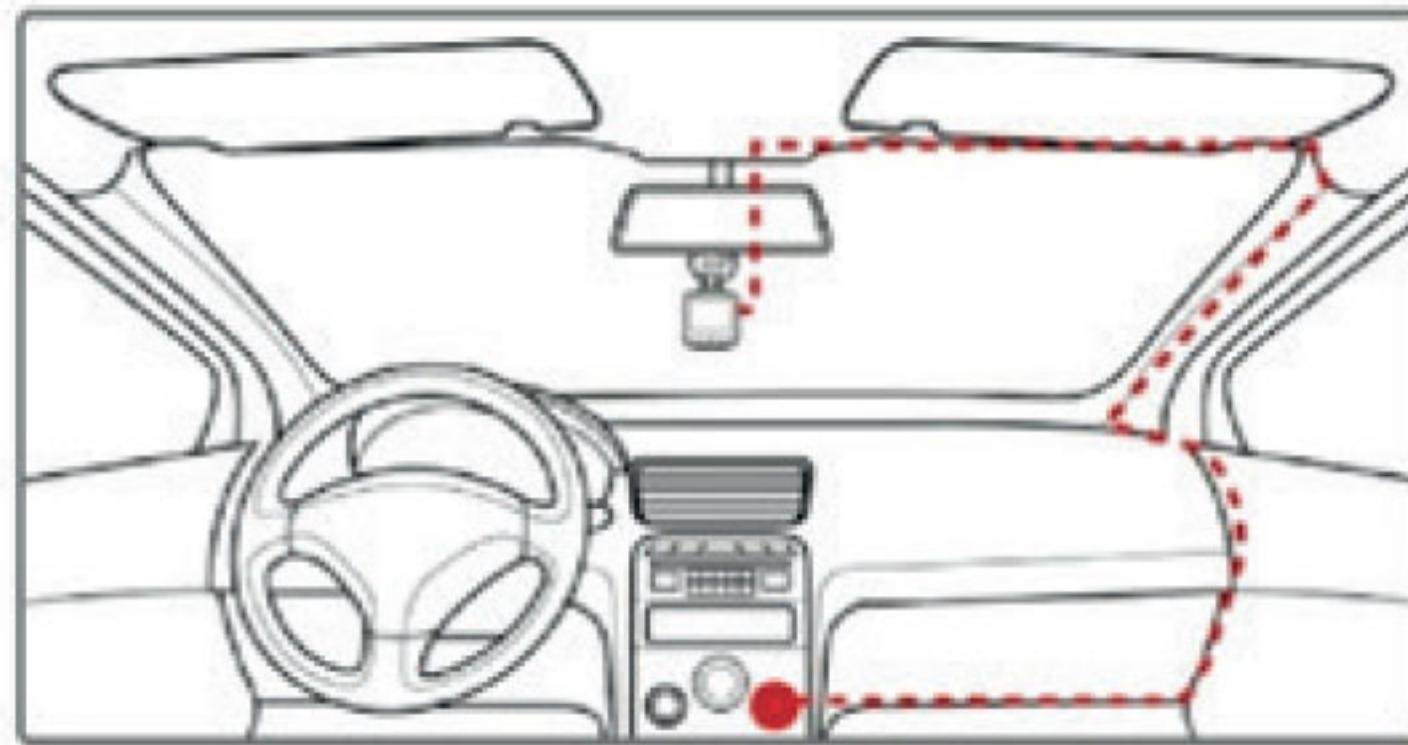
Установите магнитное крепление для лобового стекла автомобиля в специальный паз сверху устройства, не прикладывая избыточного усилия. Тщательно выберите место установки, снимите защитную наклейку с 3М-скотча и плотно прижмите крепление к лобовому стеклу автомобиля.
