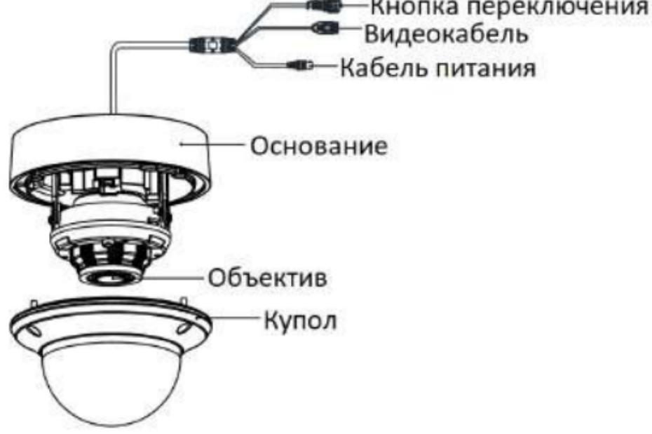
Рисунок 1-2 Камера II типа
