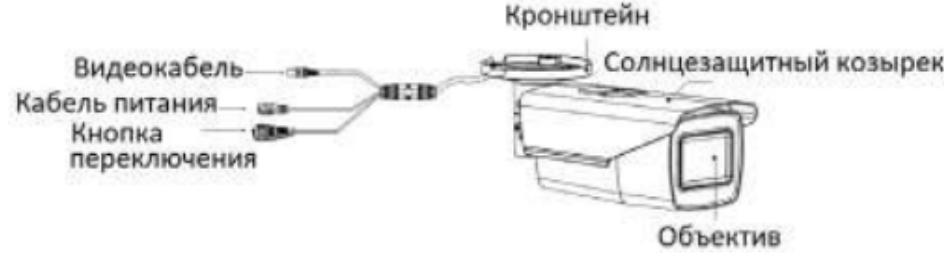
Рисунок 1-1 Камера I типа
