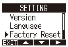
3. С помощью \_\_\_\_ и \_\_\_\_ выберите "Execute" и нажмите \_\_\_\_\_.
