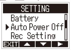
2. С помощью \_ и \_ установите время до выключения устройства и нажмите \_ .
