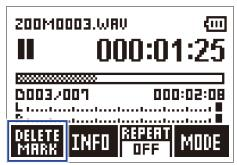
В левом нижнем углу дисплея вместо "MARK" отобразится "DELETE MARK" ("Удалить маркер").
