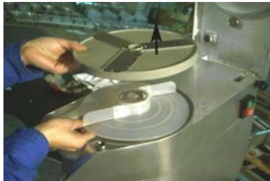
Установка режущей пластины (3)
