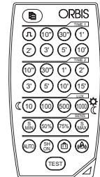
При изменении настроек CIRCUMAT PRO CR 12M с пульта дистанционного управления новые параметры будут превалировать над параметрами, заданными вручную на самом датчике ранее. Если после настройки с пульта происходит изменение настроек вручную, то ручная регулировка будет преобладать.
